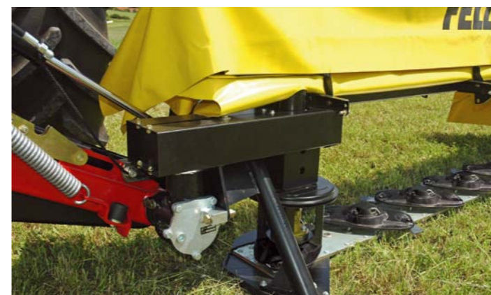
Kosiarka bez rozdzielacza wewnętrznego: napęd na pierwszą tarczę koszącą
