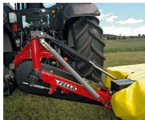
Sprężynowy mechanizm odciążający
