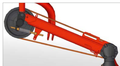
Napęd z elastycznym pasem klinowym
