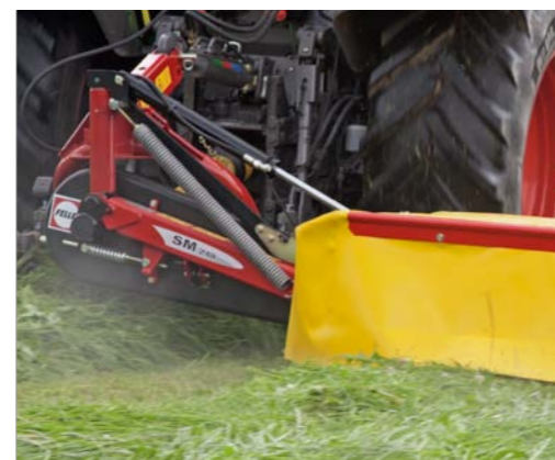
Sprężynowy mechanizm odciążający
