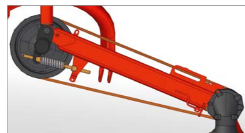
Napęd z elastycznym pasem klinowym
