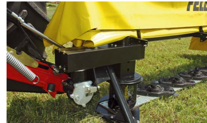
Faucheuse sans sabot intérieur : entraînement sur le premier disque faucheur
